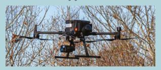
Le SDIS investi sur des **drones équipés de caméras** hautes définitions et capable de détecter des points chauds. Dans l'attente de cette nouvelle acquisition, 5 drones sont mobilisables avec une capacité de report d'image sur le terrain. Une astreinte H24 avec un télé pilote est organisée.
