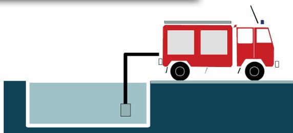
Les réserves incendie viennent compléter ou remplacer les hydrants lorsque les réseaux sous pression sont insuffisants ou absents pour fournir les débits d'extinction.
